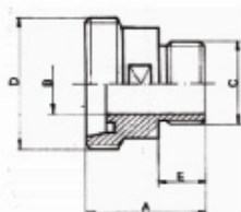
Bocchettone femmina filettato con attacco filettato GAS
